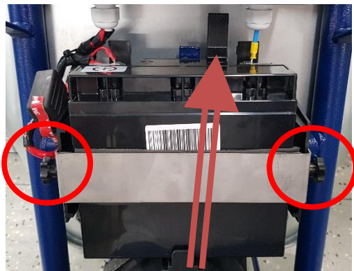
Abb. 7. – Trennen des Akkus von der Halterung Lösen von Schrauben und Akkuhalter.
